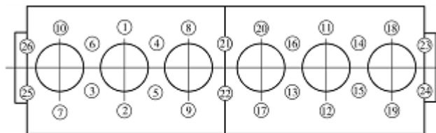
Figure 3-1 Ordre de serrage des boulons de la culasse
