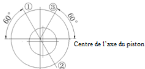
Figure 3-10 Position d'installation de l'ouverture du segment racleur
